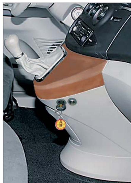
▲ Замок МКПП, штырьевой RSA-MIT-912
